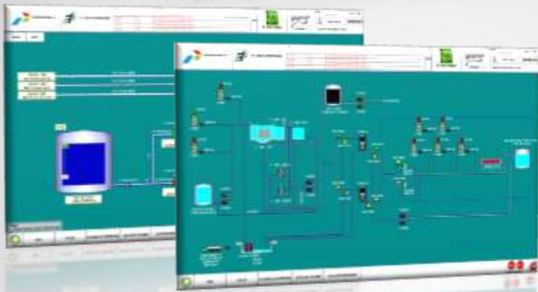
SCADA WTIP PERTAMINA EP JAMBI
